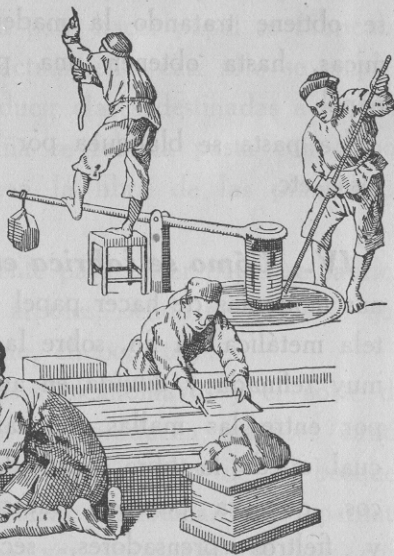
Obreros chinos moliendo la pasta con un mazo movido a pie. Otros filtran la pasta en finos tamices. A la derecha, el montón de hojas de papel prensadas con piedras
